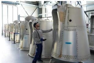
Zum Beispiel hat APCO Technologies SA eine Produktionslinie für Verbundwerkstoff-Sandwichplatten qualifiziert und eine Produktionslinie für Booster-Anbauteile für die Trägerrakete Ariane 6 qualifiziert.
