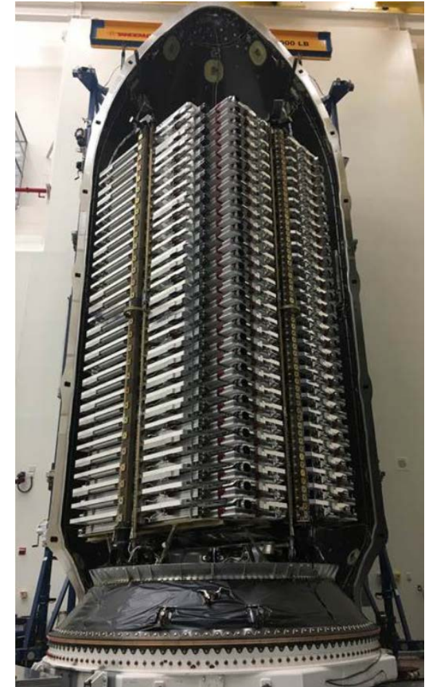
Neue Bauweise: Flatsat (Flache Satelliten)
